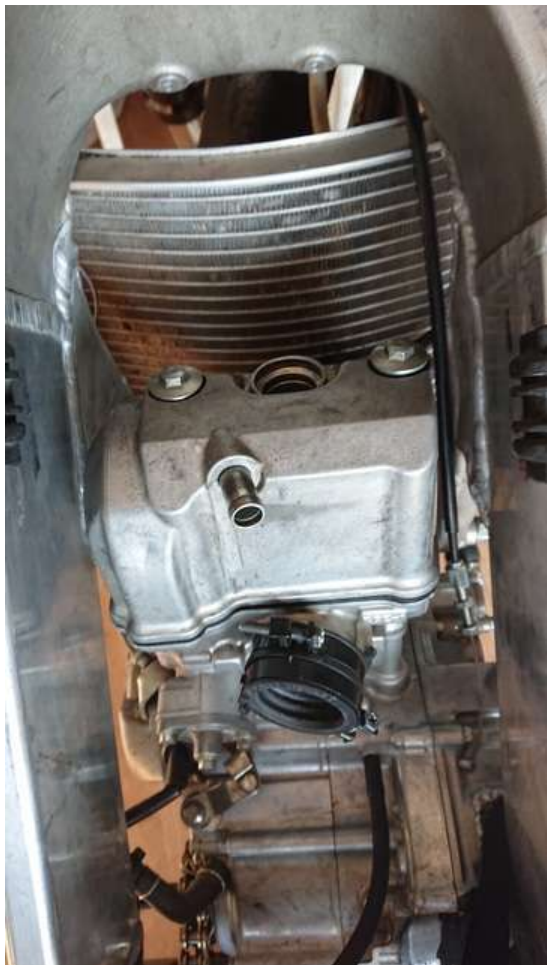
(フレームの内部のシリンダヘッドです)
